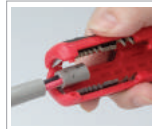
Stripping low volt cable
